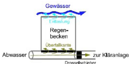
Die Funktion von Regenbecken wird oft missverstanden. Aufgrund ihrer Aufgabe sollten die Regenbecken eigentlich «Mischwasserbehandlungsanlagen» heissen. Obwohl das bestehende Mischsystem mit der Abtrennung von Saubermasser verbessert wird, werden diese Behandlungsanlagen nicht überflüssig.
